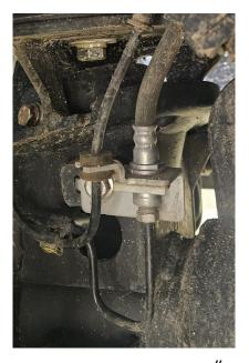
11. LOCATE THE LOWER SHOCK MOUNTS (#18378). THEY FASTEN INTO THE LOWER DEM SHOCK MOUNTS WITH THE FACTORY SHOCK BOLT.
